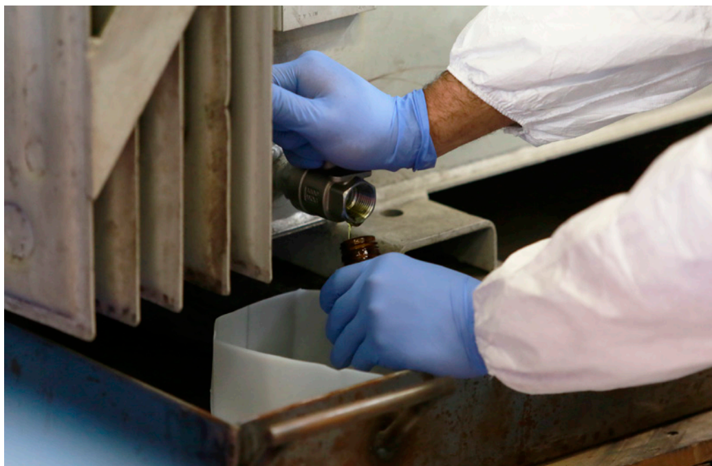
◀ Toma de muestra de aceite contenido en equipo para mantenimiento, para la determinación de su concentración de PCB
